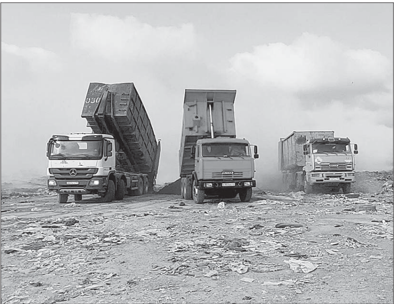
16 самосвалов один за другим подвозили грунт на полтавский полигон, засыпая место возгорания, чтобы перекрыть доступ кислорода. В итоге пожар удалось полностью потушить за несколько дней. / фото предоставлено Григорием Шаманиным.
